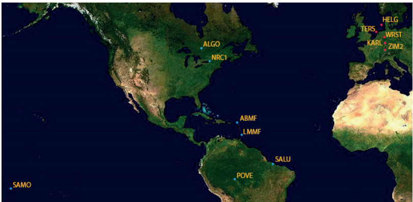
Рис. 1. Карта расположения пунктов системы IGS Multi-GNSS (MGEX), используемых в эксперименте (синий – IGS, красный – EUREF)
