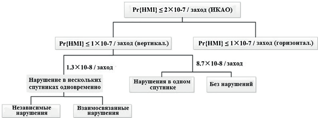
Рис. 1. Формирование требований к вероятностям опасного искажения информации Pr\{HMI\} в LPV-200
