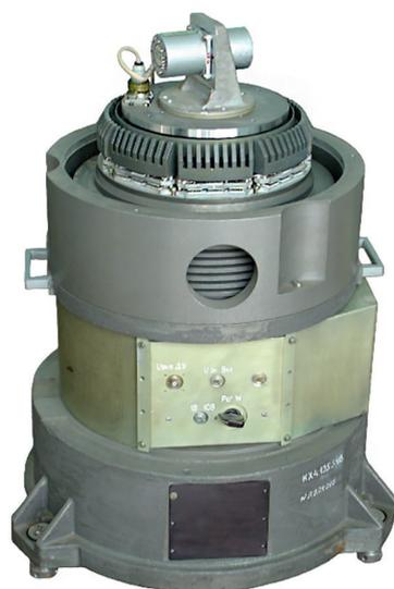
Рис. 11. Стенд с датчиком угловой скорости и КМА в качестве ИЧЭ
