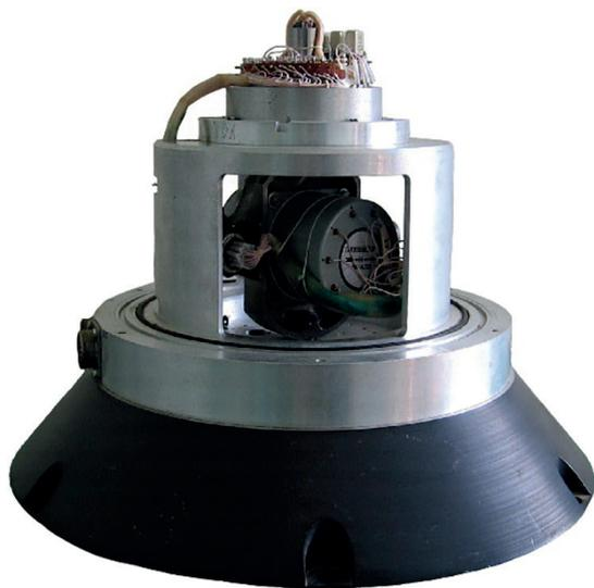
Рис. 10. Стенд с датчиком угловой скорости в режиме самоконтроля
