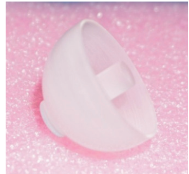
Рис. 13. Образец прецизионного гибридного резонатора с ультразвуковой шлифовкой поверхности
