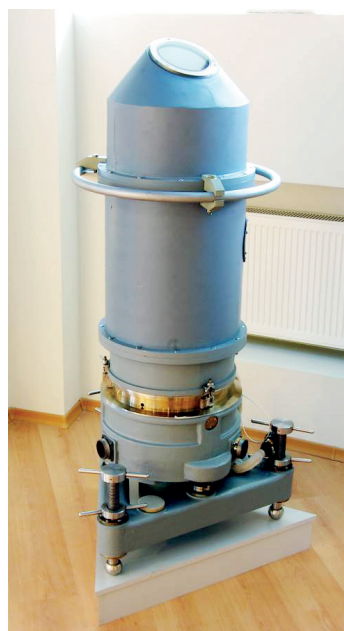
Рис. 1. Экспериментальный образец всеширотной автоматизированной астролыбии
