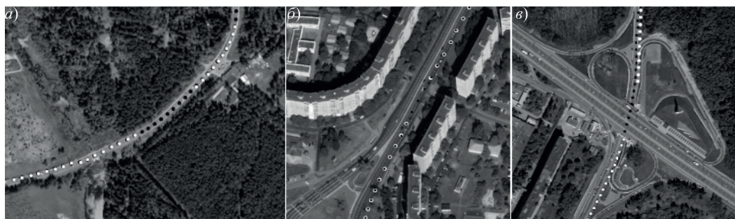
Рис. 2. Пример потери сигналов в различных условиях: а – проезд через лес; б – проезд в туннеле под Ленинградским шоссе; в – проезд в городском каньоне с высокими зданиями, г. Зеленоград. ○ – измерения ГНСС, ● – измерения ИНС
