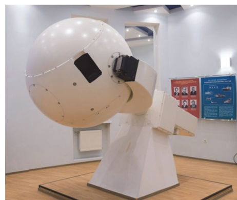
Рис. 2. Станция определения смещения центра радиоизлучения Солнца «Дрейф»
