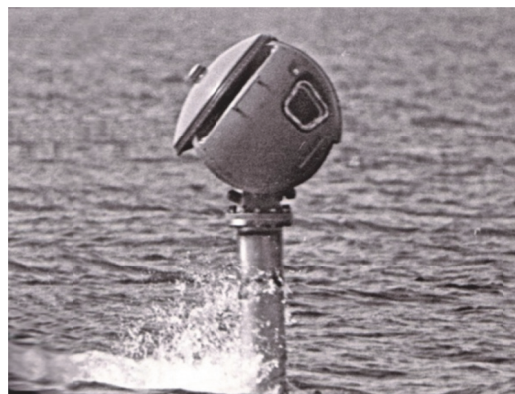
Рис. 3. Перископный радиосекстан во время обсервации
