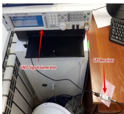
Рис. 8. Эксперимент №1: генератор навигационных сигналов и GPS/Galileo приемник
