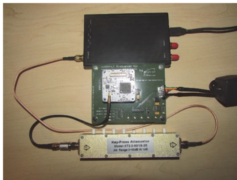
Рис. 4. Испытательная установка piNAV (форм-фактор PocketCube)
