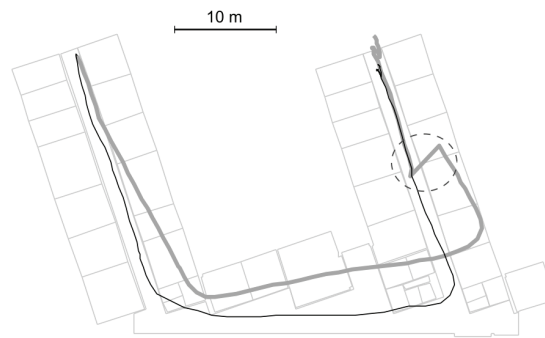
Рис. 3. Счисленное решение ( жирная линия ) и траектория, скорректированная с помощью фильтра Калмана ( тонкая линия ). Решение с использованием фильтра Калмана «возвращается» обратно в систему счисления ( штриховая зона )
