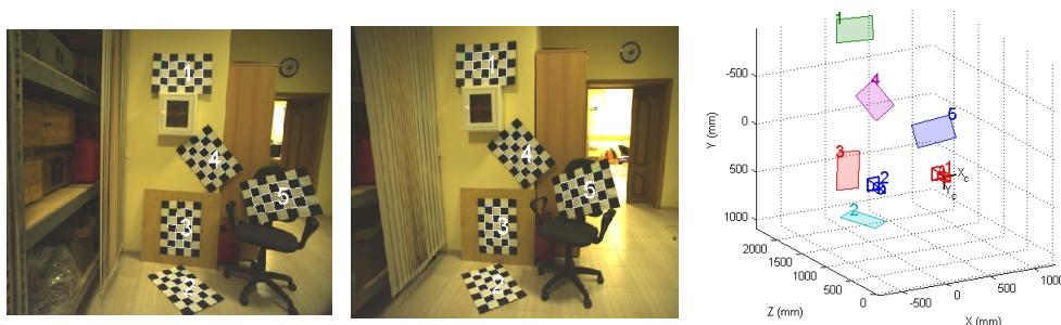
Рис. 3. Изображения, содержащие калибровочные шаблоны и визуализация пространственного положения камер и шаблонов в программной среде Matlab
