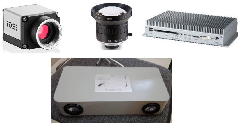
Рис. 1. Камера, объектив, вычислитель (вверху слева направо) и система технического зрения в сборе (внизу)
