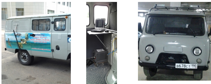
Рис. 5. Подвижный навигационный комплекс с одометром, бесплатформенной инерциальной навигационной системой и установленной на крыше автомобиля СТЗ
