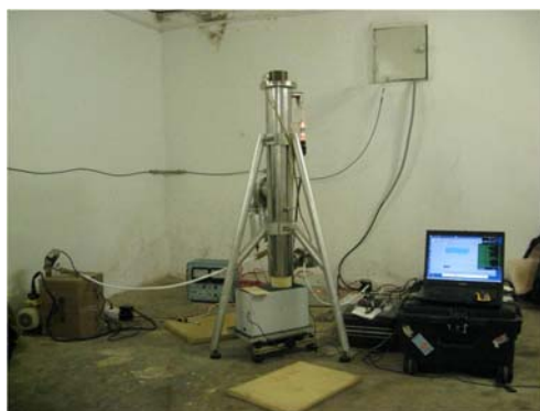
Рис. 4. Гравиметр ГАБЛ в подвальном помещении (пункт 1 на рис. 1)
