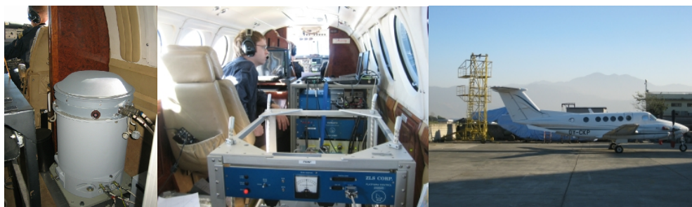
Рис. 4. Гравиметры «Чекан-АМ» (слева), «ЛаКоста-Ромберг-S34» (в центре), установленные в самолете King Air (справа)
