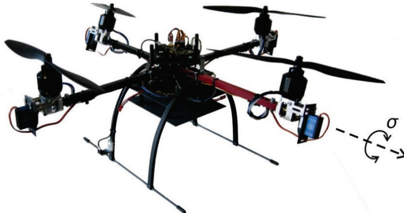
Рис. 1. Реально построенный квадрокоптер с поворотными роторами
