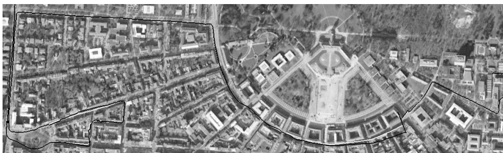
Рис. 9. Тестовый проезд А. Фрагмент проезда с привязкой к местности. Белым цветом показаны результаты работы сегментированного фильтра с использованием спутниковых разностей, черным – сильносвязанного фильтра с 15 состояниями и использованием спутниковых разностей.
