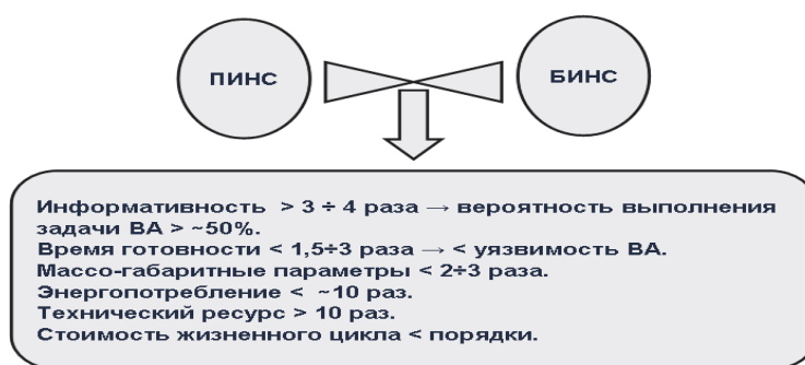
Рис. 1. Сравнение платформенных (ПИНС) и бесплатформенных систем
