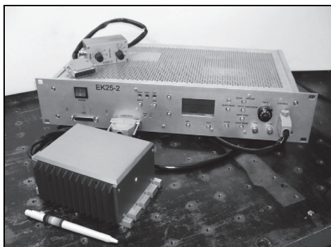
Рис. 2. Лазерная система Nd:YVO 4 /KTP/I 2 ORVILAS на длине волны 532 нм
