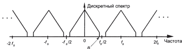
Рис. 4. Спектр дискретизированного сигнала без эффекта наложения
