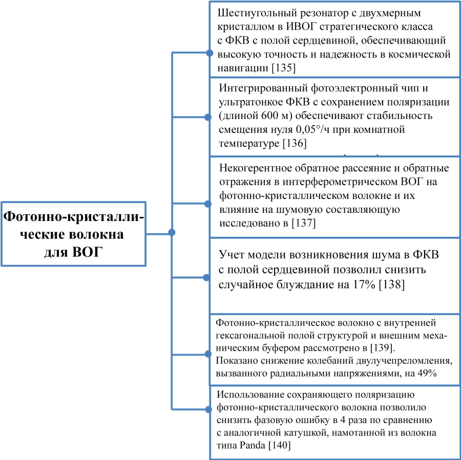
Рис. 15. Фотонно-кристаллические волокна для ВОГ
