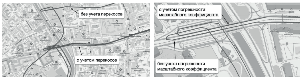
Рис. 4. Сравнение обработки результатов эксперимента с учетом и без учета погрешностей юстировочных углов (слева) и масштабного коэффициента одометра (справа)
