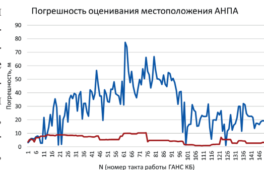
Рис. 5. Погрешности оценивания местоположения АНПА при учете погрешностей в измерениях разности времени прихода сигналов в диапазоне (-0,3 \cdot 10^{-4}, 0,3 \cdot 10^{-4}) с (синяя кривая – без измерения частоты входного сигнала, бордовая кривая – с измерением частоты входного сигнала)
