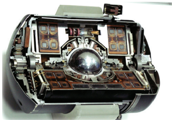
Рис. 2. Электростатический гироскоп (фото из музея ОАО «Концерн «ЦНИИ «Электроприбор»)
