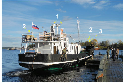
Рис. 3. Расположение антенных модулей: 1 – антенны изделия «ИСОН-1», 2 – антенны изделия «Вега», 3 – антенна приемной аппаратуры Javad
