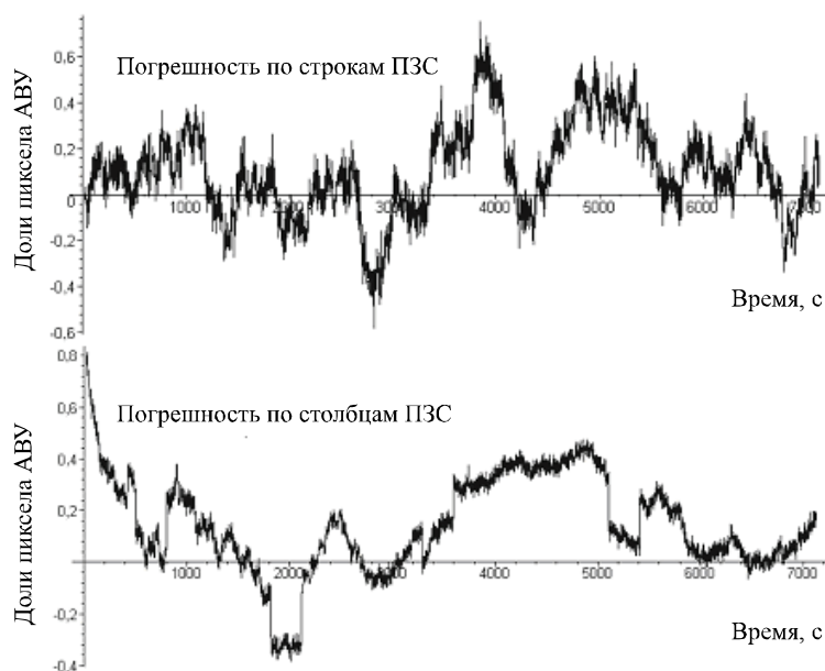
Рис. 10. Погрешности БИНС на пятиминутных интервалах времени, приведенные к плоскости ПЗС-матрицы
