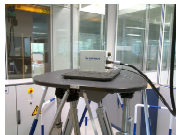
Рис. 13. Компас BlueNaute™, испытание на гексапode
