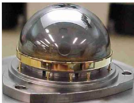
Рис. 3. 20-мм резонатор ВТГ производства Sagem
