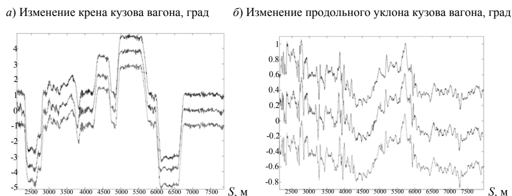
Рис. 6. Характеристики положения пути относительно плоскости горизонта
