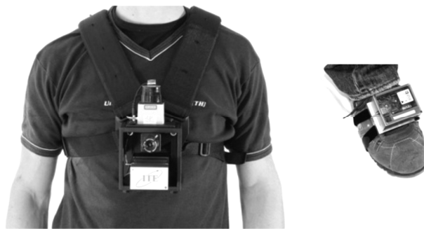
Рис. 1. Многосенсорная индивидуальная навигационная система IndoorGuide , включающая блок на торсе человека (ИИМ 1 - слева) и на ноге (ИИМ 2 - справа)
