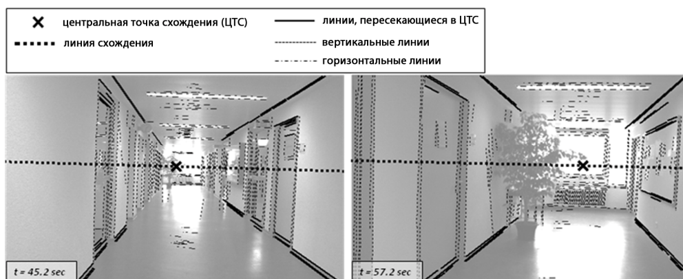
Рис. 4. Два изображения с реального испытательного запуска: извлеченные линейные фрагменты, \vec{\omega}_{corr} расчетная ЦТС и расчетная линия схождения. Из координат ЦТС и наклона линии схождения выводится изменение трехмерной ориентации: углы крена, дифферента и рыскания
