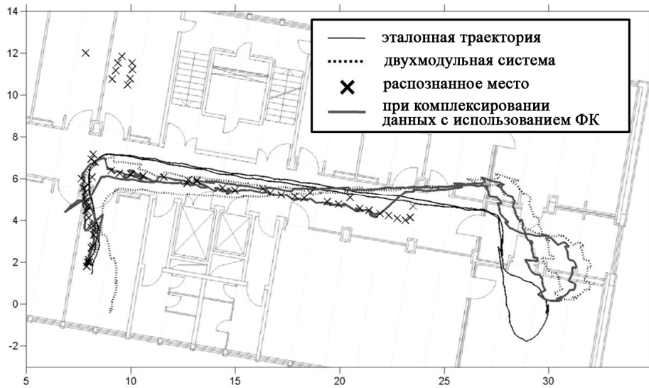
Рис. 7. Пройденная траектория и оценка, выработанная с помощью адаптивного ФК, который обрабатывает видеоизмерения местоположения и ориентации
