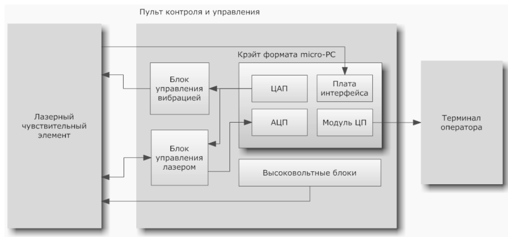
Рис. 5. Структурно-функциональная схема ТКПА М-40
