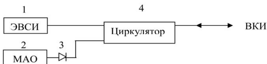
Рис. 3. Компоненты ВОГ, размещенные в одном корпусе: 1 – ЭВСИ, 2 – плата МАО, 3 – PIN-фотодиод, 4 – оптический циркулятор (или волоконный трехпортовый разветвитель)
