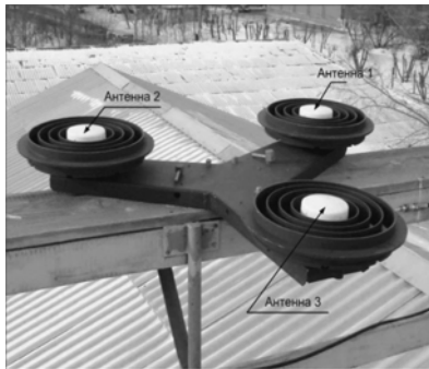
Рис. 6. Антенная система аппаратуры МРК-32 (а); расположение НКА во время проведения эксперимента (б)
