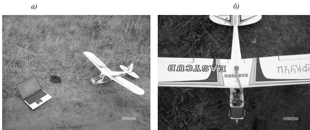
Рис. 17. Авиамодель EasyCub, оборудованная ПВ: а) внешний вид; б) размещение ПВ на крыле
