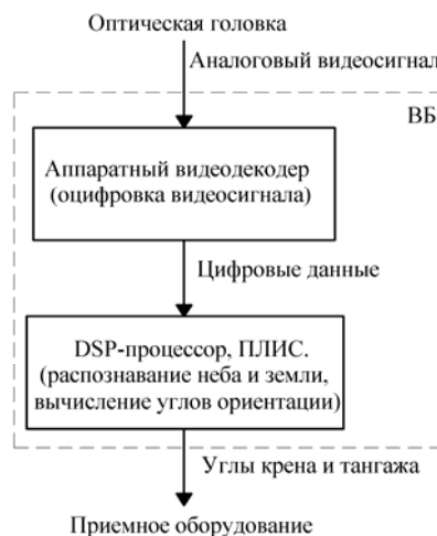
Рис. 14. Функциональная схема вычислительного блока
