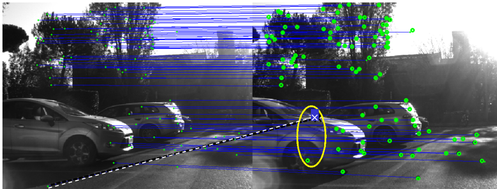
Рис. 2. Натурный эксперимент №1. Пары изображений с соответствиями точек и результатами оценки. Точки слева – согласованные элементы SIFT, кружки справа – элементы, перепроецированные с помощью оценки по методу LEL
