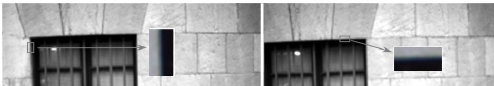
Рис. 1. Пример возможной неопределенности согласования, связанной с использованием ковариантных детекторов элементов (например, SIFT)
