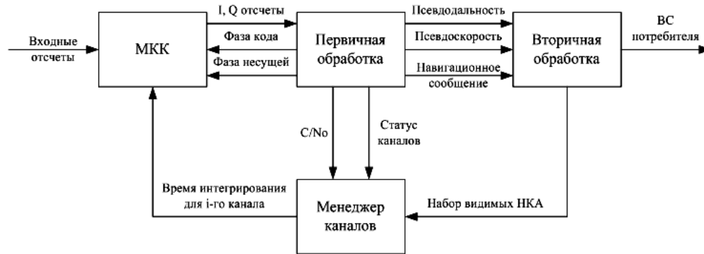
Рис. 2. Архитектура ПО MosaicGNSS
