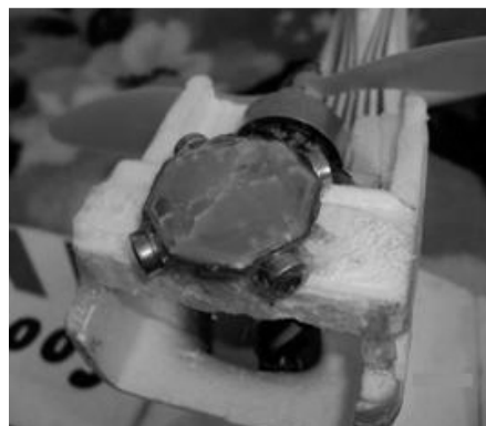
Рис. 10. Пировертикаль с четырьмя пирометрами на БПЛА «Кута»
