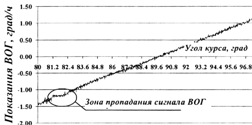
Рис. 9. Выходной сигнал ВОГ после доработки
