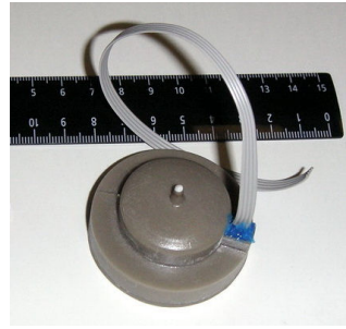
Рис. 3. Молекулярно-электронный датчик вращательного движения диаметром 50 мм
