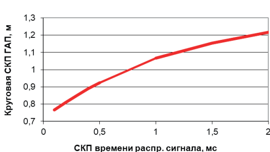
Рис. 3. Зависимость круговой СКП определения горизонтальных координат ГАП от СКП измерения времени распространения сигнала от излучателя до ГАП при глубине моря 2000 м
