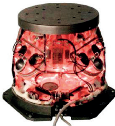
Рис. 7. Моноблочная конструкция трехкоординатного ЛГ
