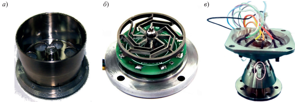
Рис. 24. ВТГ с металлическим цилиндрическим (а) [38], кольцевым (б) [39] и колоколообразным (в) резонаторами [40]
